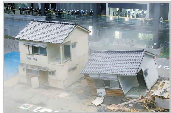
平成17年 既存住宅移築補強・無補強実験(J形瓦)
