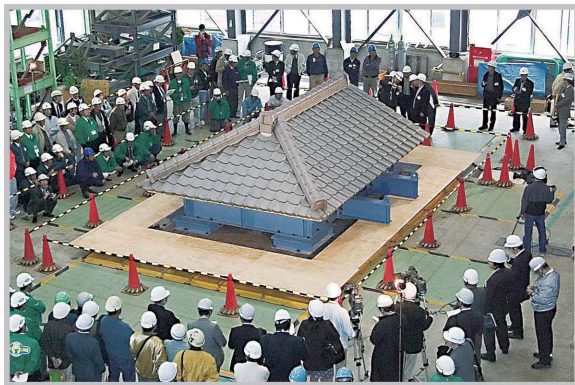
平成16年 瓦屋根の耐震実験(J形瓦)
