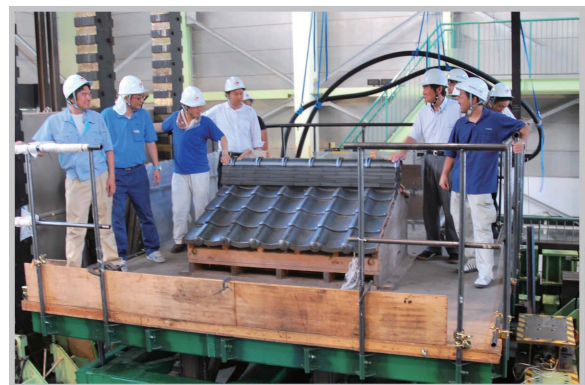
平成24年 瓦屋根の耐震実験(J形瓦)
